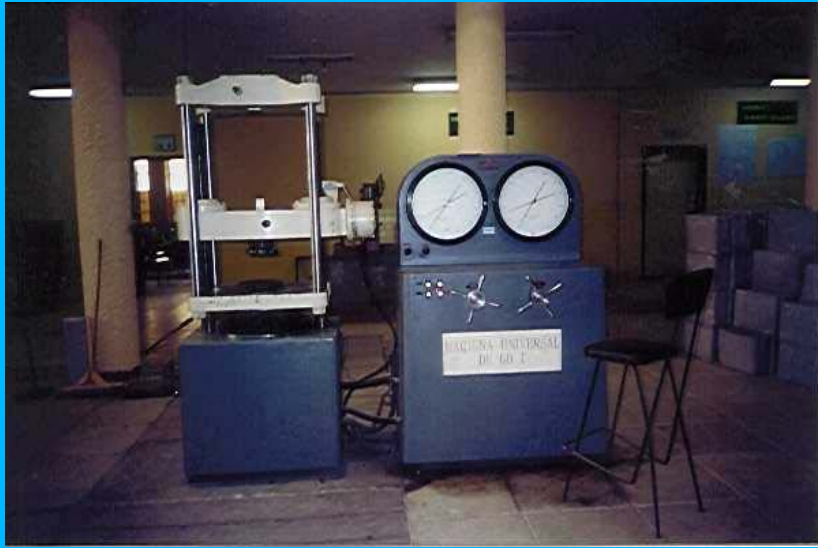
Foto No. 22 Máquina de compresión Universal 100 tn.
