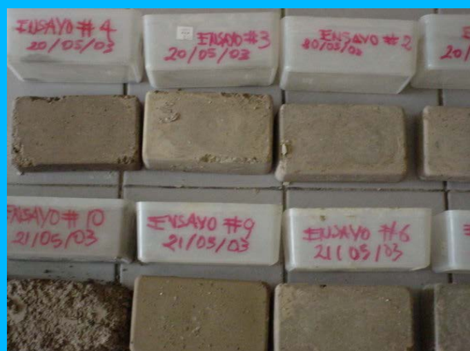
Foto No. 15 Bloques inertizados (primera prueba)
