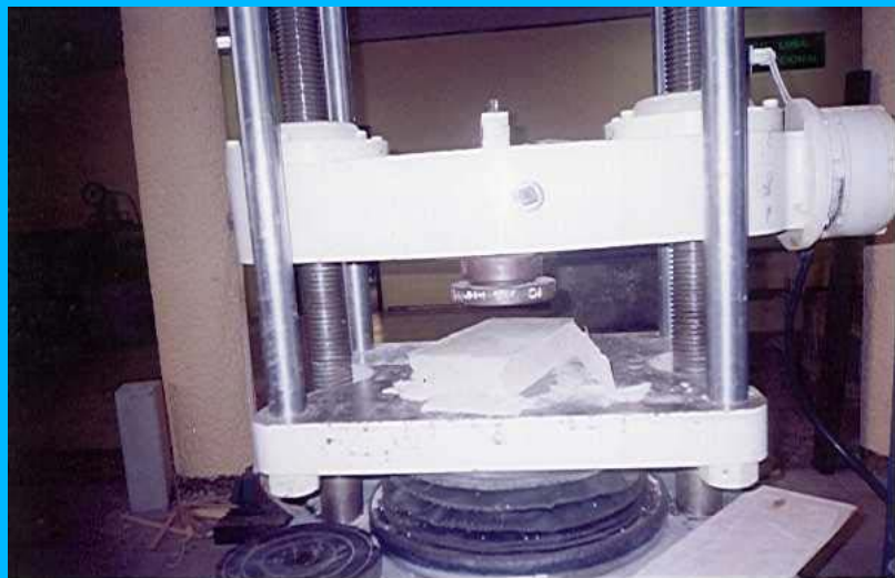
Foto No. 19 Ensayo de compresión a los bloques inertizados
