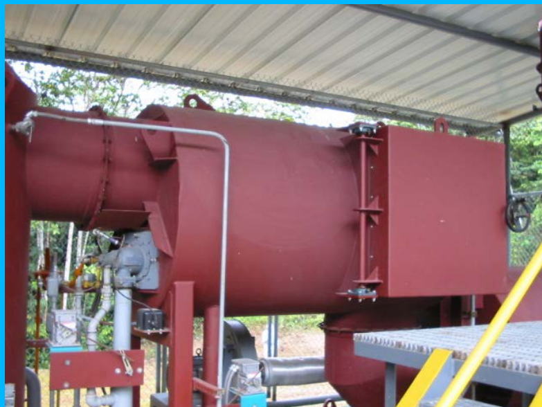
Foto No. 8 Cámara de combustión secundaria
