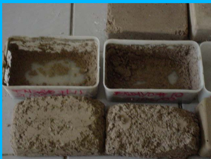
Foto No. 17 Ensayos N y O con mínima resistencia
